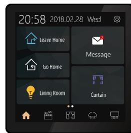
4吋智能終端是一款高清液晶觸控終端，能夠代替燈控、窗簾觸控面板及空調面板，從而實現集中控制，同時支援情境模式控制，能夠讓使用者得到更佳的智慧體驗。
